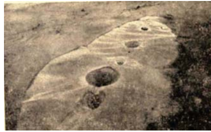
Fig. 2.31 Lichefiere - cutremurul din 4 Martie 1977: Bucuresti (stanga) si Buzău (dreapta) Foto © Cutremurul de pamant din Romania de la 4 Martie 1977, Monografie, 1982
