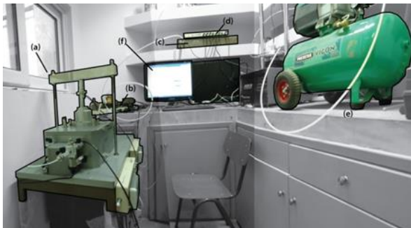
Φωτ 3. Συνολική πειραματική διάταξη που χρησιμοποιήθηκε και αποτελείται από: (α)Συσκευή διάτμησης, (β)Ελεγκτή πιέσεων νερού, (γ)Ελεγκτή πιέσεων αέρα, (δ)Κονσόλα δεδομένων οχτώ (8) καναλιών, (ε)Γεννήτρια συμπίεσης αέρα και (στ)Ηλεκτρονικό υπολογιστή.
