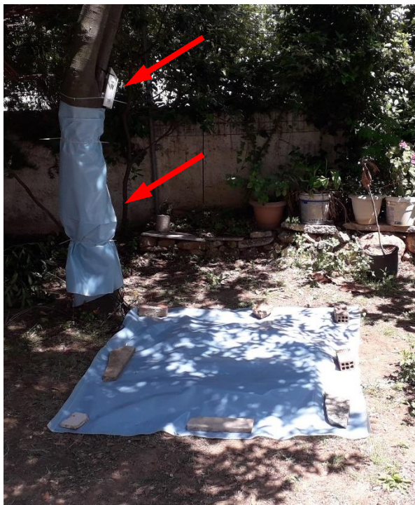
Φωτ. 3. Διάταξη μετρήσεων Αρτέμιδας, 2019, κατά το στάδιο κάλυψης με μεμβράνη της επιφάνειας διαβροχής. Επισημαίνονται με βέλη το καταγραφικό (πάνω) και η κάλυψη των καλωδίων προς αυτό για θερμομόνωση.
