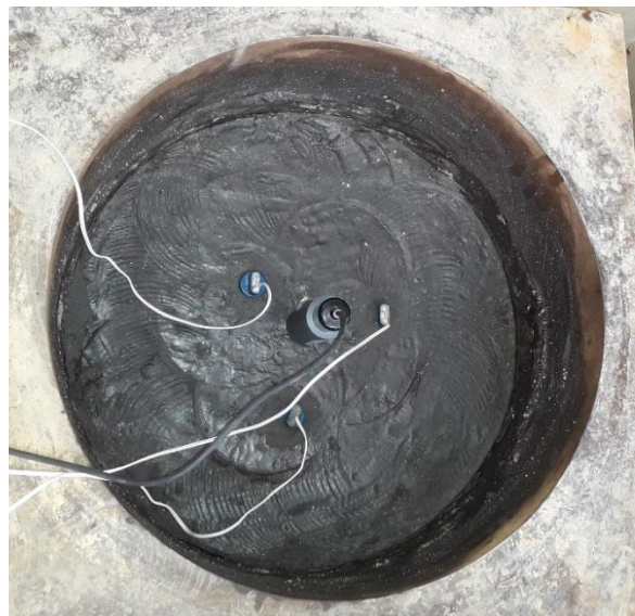
Φωτ. 4. Δοκίμιο μεγάλων διαστάσεων Αργίλου Κέρκυρας με εγκατεστημένα όργανα παρακολούθησης στη στρώση που τοποθετήθηκαν.
