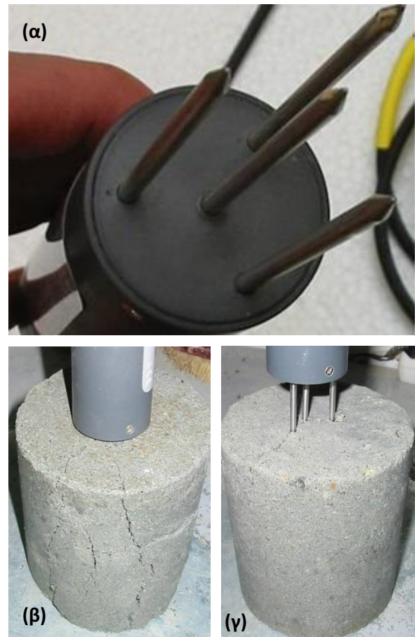
Φωτ. 1. α) Ο αισθητήρας ML-2x, β) διείσδυση σε δείγμα με τη βέλτιστη υγρασία, και γ) σε υγρασία ξηρά από τη βέλτιστη.
