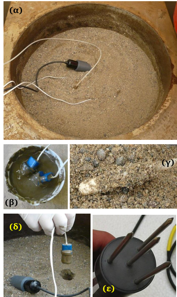
Φωτ. 1. α) Δοκίμιο μεγάλων διαστάσεων χονδρόκοκκης άμμου με εγκατεστημένα όργανα παρακολούθησης στη στρώση που τοποθετήθηκαν, β) τεμάχια γύψου εντός πολλού ιλυώδους εδάφους, γ) κεφαλή τενσιόμετρου χαμηλής πίεσης διεύθυνσης αέρα μετά την εξαγωγή του από το δοκίμιο, δ) το ένα από τα τεμάχια γύψου κατά την τοποθέτησή του σε οπή στο δοκίμιο, και ε) ο αισθητήρας μέτρησης ογκομετρικού ποσοστού υγρασίας ThetaProbe.
