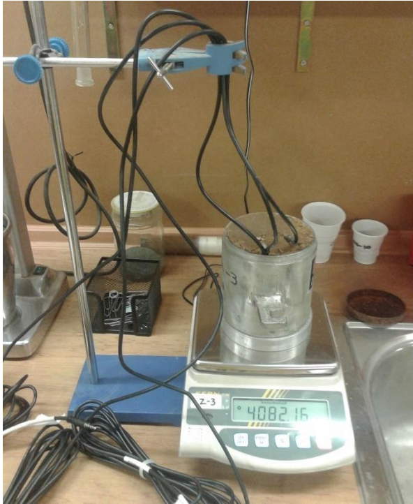
Φωτ. 2. Εργαστηριακή διάταξη μέτρησης χαρακτηριστικής καμπύλης εδάφους-νερού σε δείγμα από το Σταθμό Αρτέμιδας μετά την ανάσχυση των αισθητήρων της περιόδου μετρήσεων 2013 με τους ίδιους αισθητήρες.
