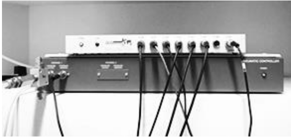
Φωτ 2. Πνευματικός ελεγκτής υψηλής ακρίβειας αέρα.
