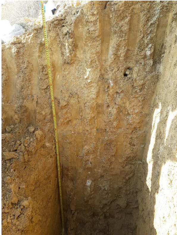
Φωτ. 5. Τομή ερευνητικού φρέατος εντός του οποίου εγκαταστάθηκαν οι αισθητήρες (στην πλευρά απέναντι από τη θέση λήψης).
