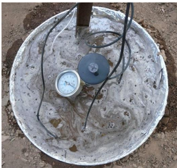
Σχ. 5. α) Σχηματική παρουσίαση θέσης κύριας διάταξης και διάταξης αναφοράς, β) φωτογραφική άποψη της θέσης τους, και γ) κοντινή άποψη της κύριας διάταξης από πάνω κατά τη δοκιμή διαβροχής.
