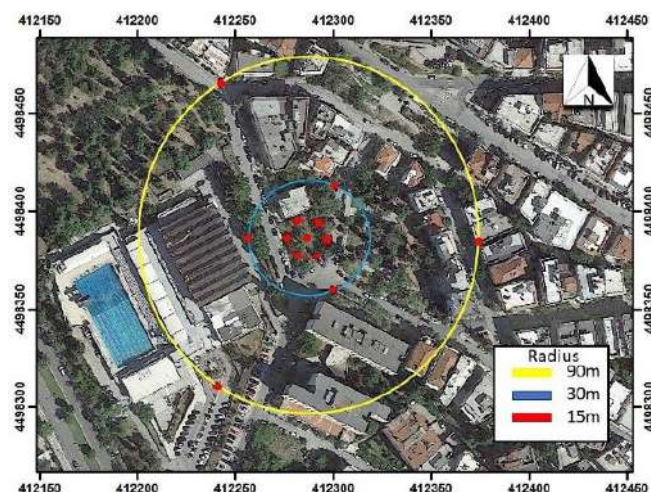
Σχήμα 1. Ανάπτυγμα ειδικού δικτύου σεισμομέτρων μέτρησης εδαφικού μικροθορύβου στην περιοχή μελέτης.
