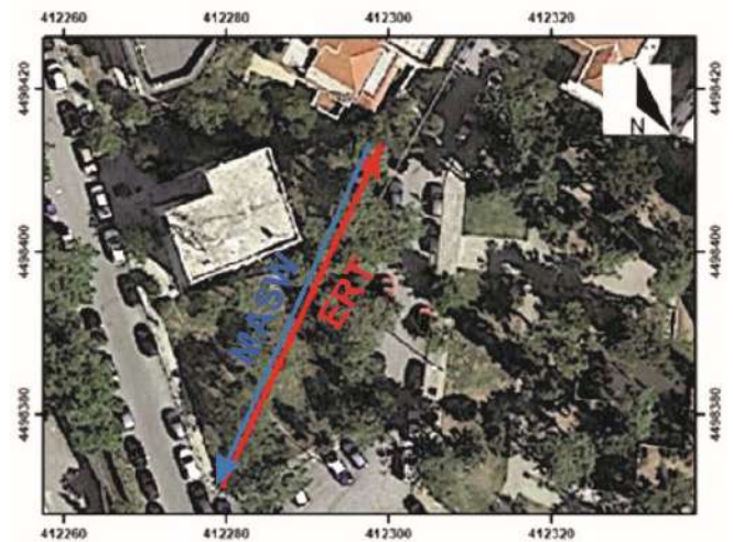
Σχήμα 6. Γραμμή ηλεκτρικής τομογραφίας και M.A.S.W. η οποία διέρχεται από τη θέση του κεντρικού σεισμομέτρου κατά τη διεξαγωγή παθητικών μετρήσεων με την τεχνική ειδικών δικτύων σεισμομέτρων
