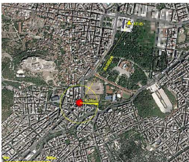
Σχήμα 1. Κάτοψη της περιοχής του κέντρου της Αθήνας που περιλαμβάνει τη θέση της έκρηξης (Λεωφ. Συγγρού, 3) και το κτίριο της Βουλής των Ελλήνων όπου είναι εγκατεστημένος ο σειсмоγράφος/επιταχυνσιογράφος του ΙΤΣΑΚ (ATH5)
